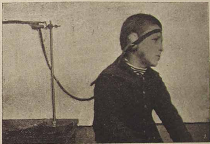
FIG. 9. — Pletismografo auricolare, di cui è derivazione il pletismografo facciale descritto nel testo.
