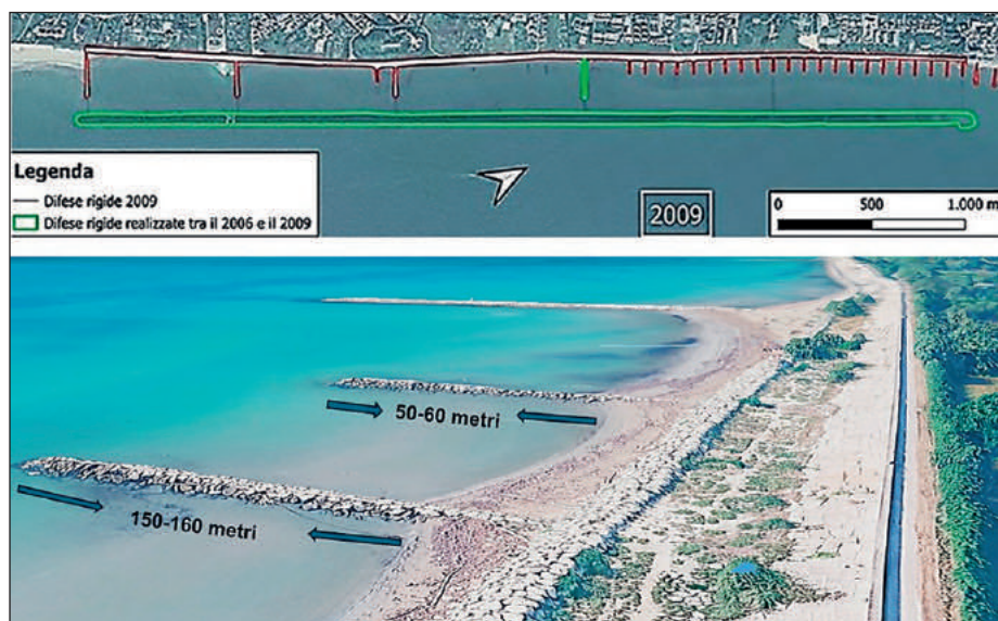
Fig. 14 – In alto: I Murazzi (doppia linea), i 27 pennelli (rosso), la diga soffolta (verde) (Peschutta, 2020); in basso: i Murazzi e i pennelli trasversali (Google Earth, 2024).
